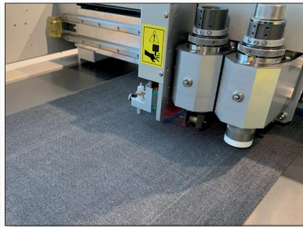
Vakuumsaugband für sichere Produktpositionierung
