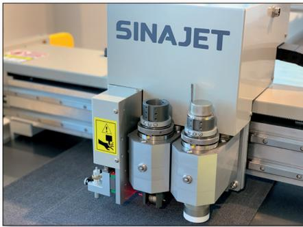
Schneidkopf mit schnellem Servoantrieb
